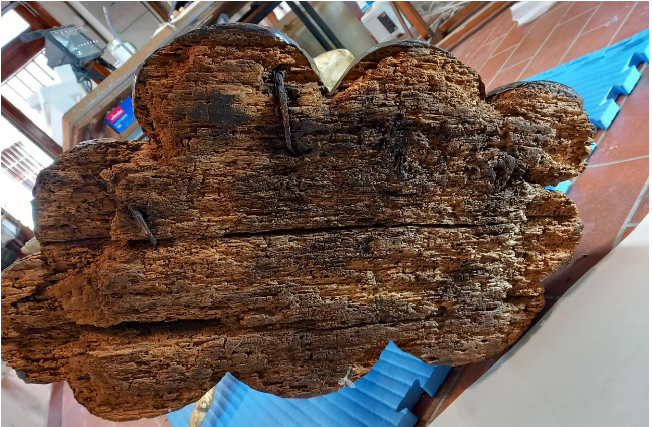
Piedistallo dell'angelo inginocchiato dopo il consolidamento con il Paraloid
